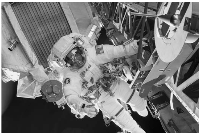
Астронавт К. Кэссиди около шлюзового модуля "Квест" укладывает кабели системы энергопитания для российского лабораторного модуля "Наука". 9 июля 2013 г. Фото NASA.
